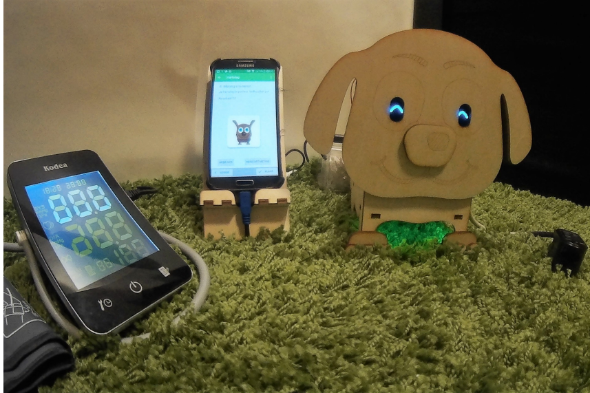
Figuur 5.1: Het volledige systeem. Van links naar rechts: de bloeddrukmeter, het docking station met smartphone, de robot, de hartslagmeter.
